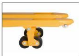
Telipyörien edessä ja takana olevat apupyörät helpottavat pääsyä kuormalavojen alle ja nopeuttavat työskentelyä.
