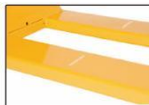
Kuormalavan poikittaiskäsitteilyyn tarkoitettuja huomiomerkit ehkäisevät kuormalavan rikkoutumisen.
