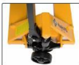
190° Kääntökulma mahdollistaa ketterän liikkumisen ja huoltovapaa hydraulikkayksikkö takaa huolettoman käytön.
